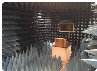
周波数特性のシミュレーション測定器や電波暗室による実機での検証
